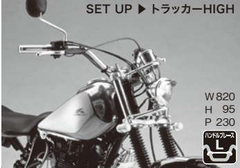
TW225E, TW200E('00~ ディスクブレーキ車) HBK517-01 ¥11,100 ポジション 30mmアップ 70mmバック
