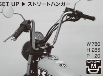
250TR('07~ FI車) HBK642S ¥24,000 250TR(~06 キャブ車) HBK641S ¥23,600 ポジション 140mmアップ 20mmバック
