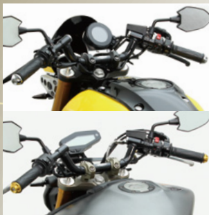
MT-09ポジション例:100mmダウン 50mm前方へ 絞り角+7度 ハンドル巾-100mm(構造変更必要)
