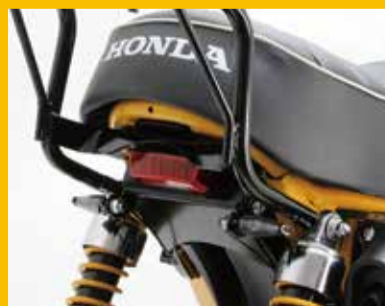
テールランプkit LEDレクタングルテールランプ ※右記マッドガードとウィンカーの交換が必要 HA5820R ¥未定
