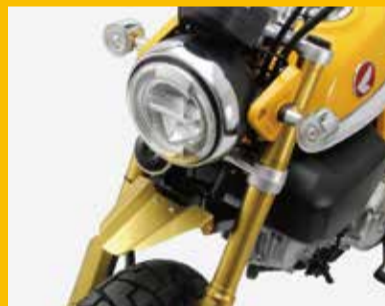
フロントフェンダー アルミ製 ショートタイプ <参考出展>
