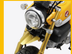
フロントフェンダー アルミ製ショートタイプ 2ピース カラーは4色の予定 HA6515G 価格未定
