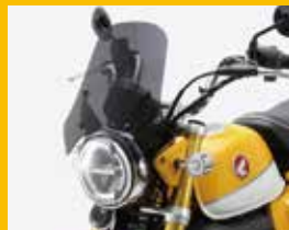
スクリーン 簡単に取付けできる専用アルミステー付 国産アクリル樹脂製3mm厚 スモーク HA6101 ¥17,000
