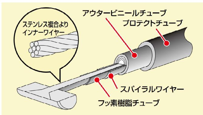
ブラックケーブル、ステンレスメッシュケーブル共に、インナーワイヤーはステンレス鋼線7×7の複合よりで、表面にスエージング加工を施し滑らかで伸びの少ない高張力ワイヤーです。又、スパイラルワイヤー内側にフッ素樹脂チューブを使用していますので摩擦係数が少なく、軽くて滑らかなレバーワークを実現します。
